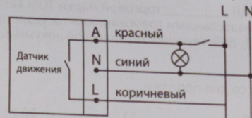
Рисунок 9. Схема с добавлением настенного выключателя в цепь для ручного подключения нагрузки
