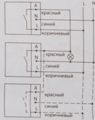
Рисунок 11. Пример подключения двух и более датчиков движения к общей нагрузке
