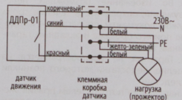
Рисунок 7. Схема подключения датчиков ДДПр-01 с прожектором
