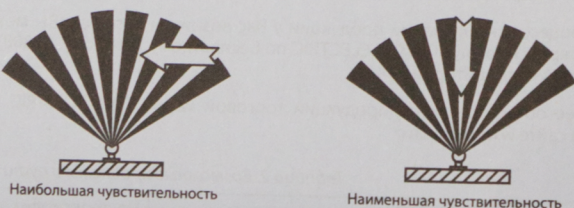
Рисунок 4. Зависимость чувствительности датчика от направления движения объекта
